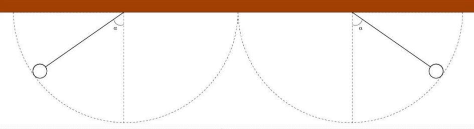
Fig. 1 Dos péndulos sincronizados con fases opuestas
